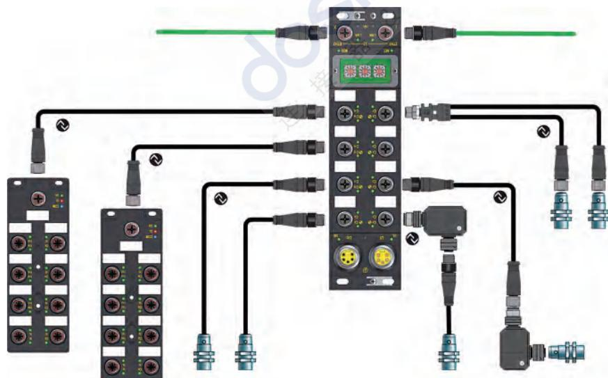
**IO-link连接技术示意图**
